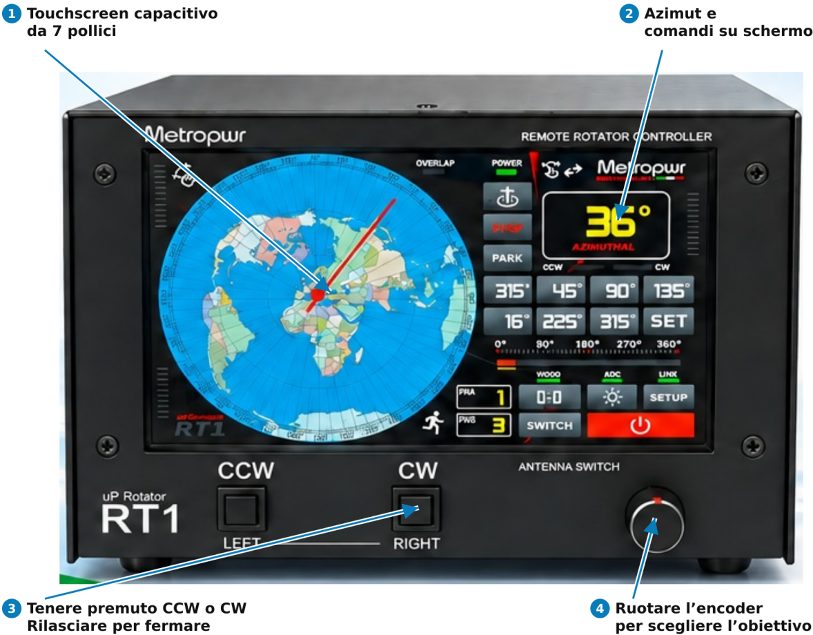
Figura 20 Frontale RT1 con touchscreen tasti manuali ed encoder
